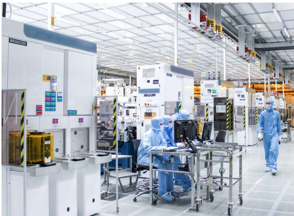
Au sein de l'une des salles blanches de l'entreprise STmicroelectronics : un lieu d'une extrême propreté, car la fabrication des semi-conducteurs ne tolère aucune poussière, même en suspension !
