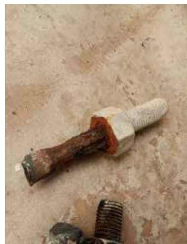
Poutrelles affaiblies, garde-corps rongés, boulons usés... Au cours des décennies, la corrosion avait largement fait son œuvre, sur l'ensemble des pièces métalliques de la structure.
