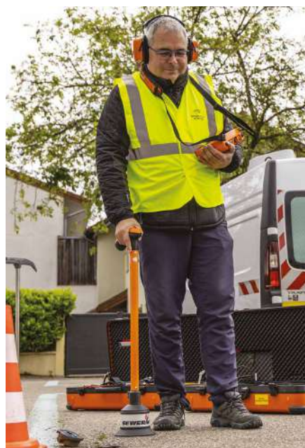
Cet agent recherche la propagation du bruit d'une fuite à travers le sol ou une canalisation grâce à un détecteur électro-acoustique.
