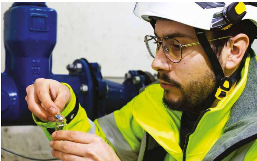
Rafaël mesure le taux de chlore en sortie d'un réservoir d'eau potable.
